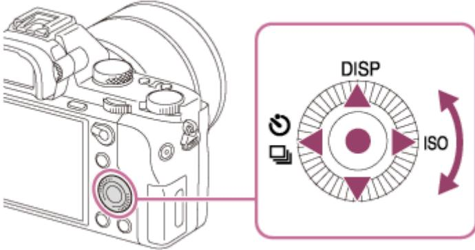
Вы можете выбрать пункты установки, поворачивая или нажимая верхнюю/нижнюю/правую/левую сторону колесика управления. Ваш выбор будет принят при нажатии ● в центре колесика управления.
